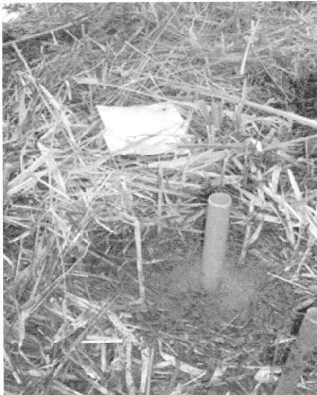
4. kép A csapdásokban elhelyezett talajvízszintmérő, perforált műanyag csövek a telepítésük után (2005. 04. 01)
